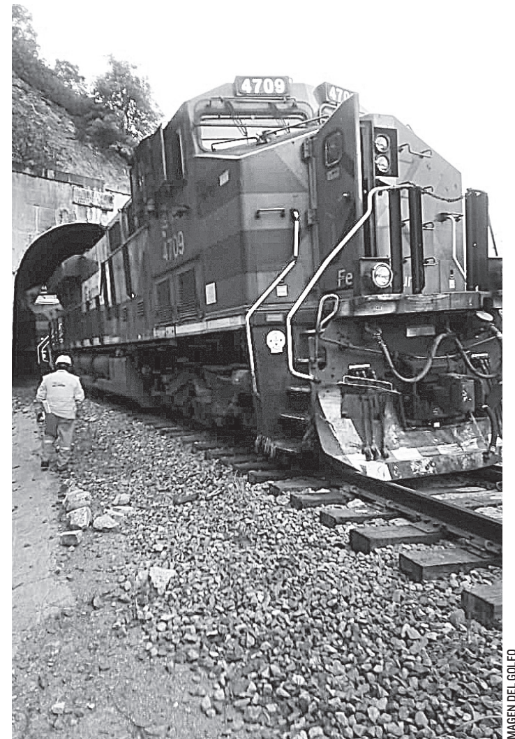
EL ROBO DE LAS FIJACIONES, grapas y contrarrieles, provocaron que el tren se saliera de la línea de rodamiento.
